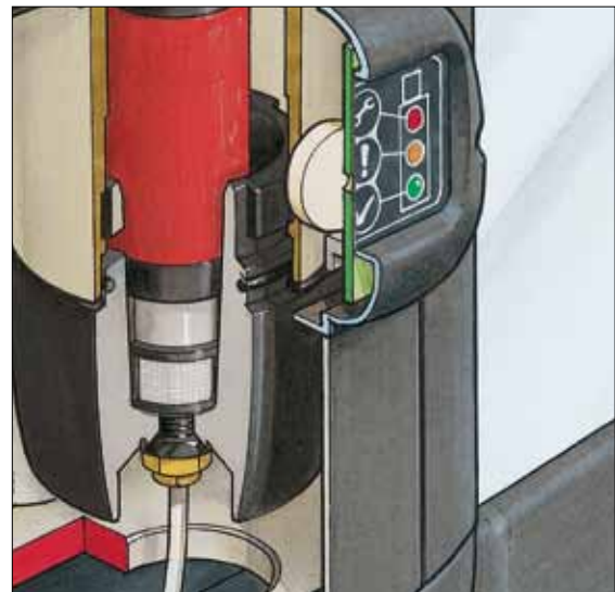
Integrierter Hochleistungsfilter 0,01 µm.
